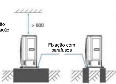
Figura 2-3.2: Vista lateral da instalação de somente uma unidade central (dimensões: mm)
